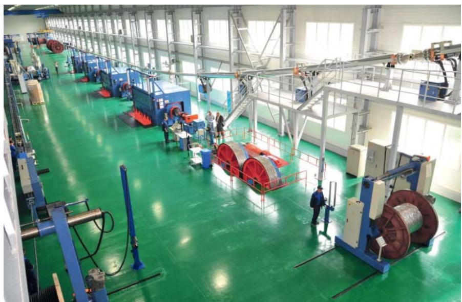
Новый цех по производству силовых кабелей с изоляцией из сшитого полиэтилена на напряжение 10–110 кВ
