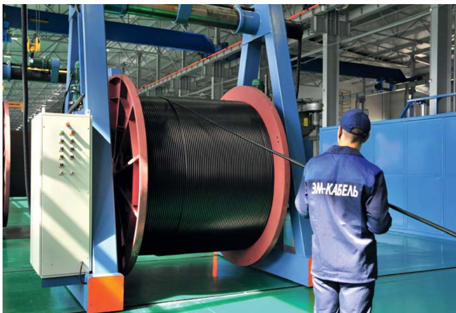
Производство изолированной жилы для кабеля на напряжение 10 кВ
