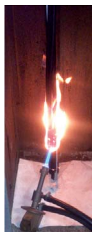
Испытания на нераспространение горения
