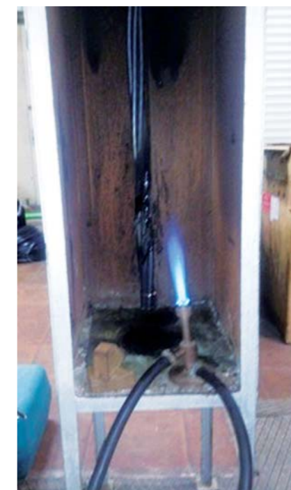
Затухание СИПн через 2 секунды после удаления горелки
