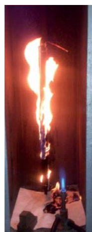
Горение СИП после удаления горелки при вертикальной прокладке
