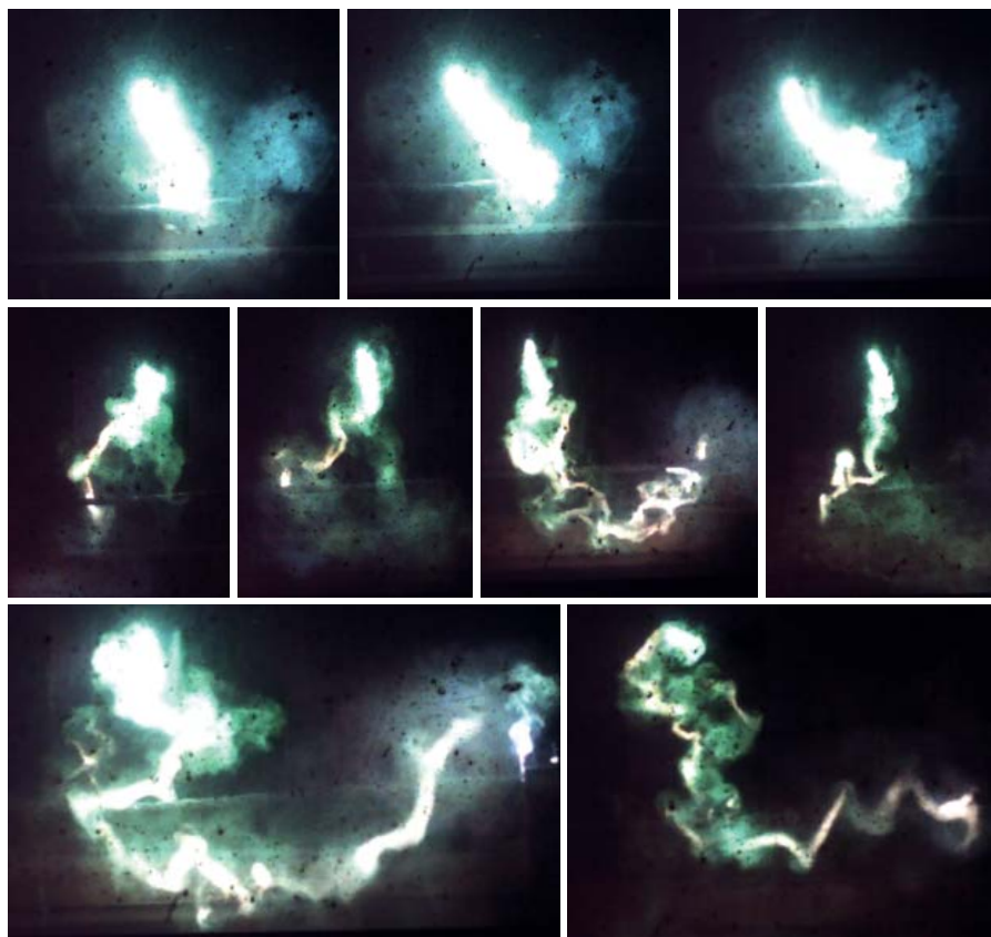
Рис. 2. Смещение канала разряда под действием электромагнитных сил
