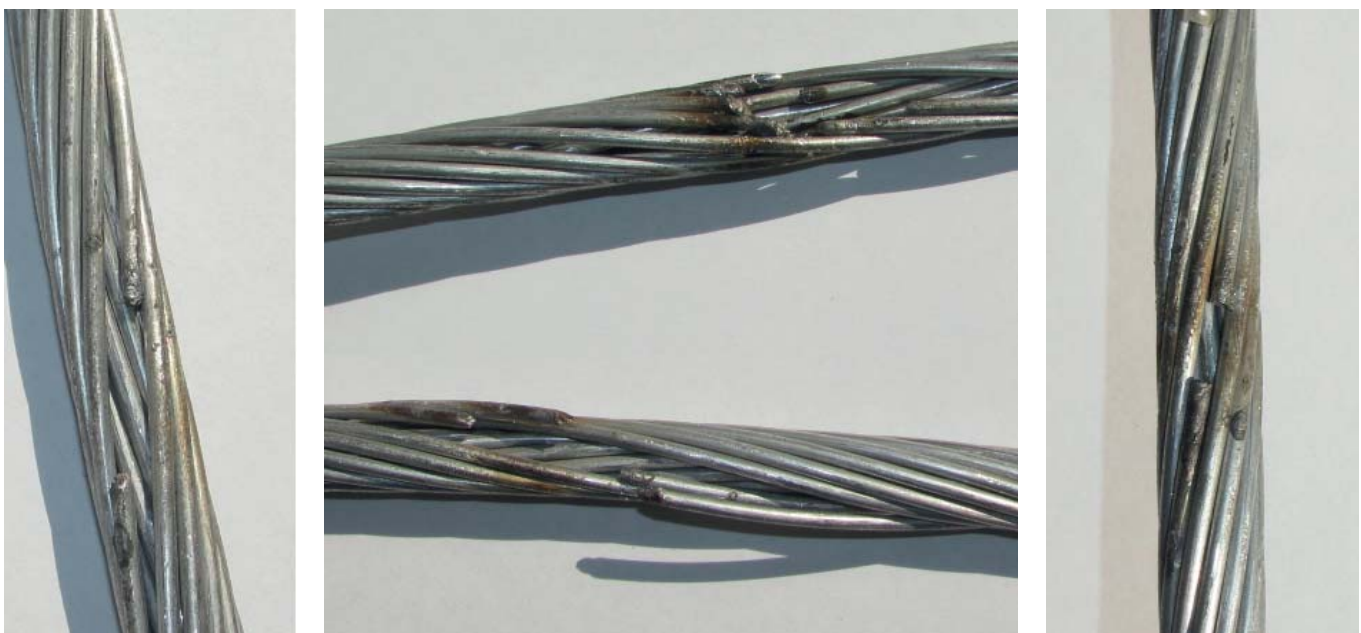
Рис. 1. Участки троса после воздействия молнии с переносимым разрядом 40 Кл и 100 Кл
