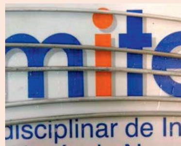
Фото 4. Провода из стали, плакированной алюминием, класс 14SA, после 1840 ч испытаний.
