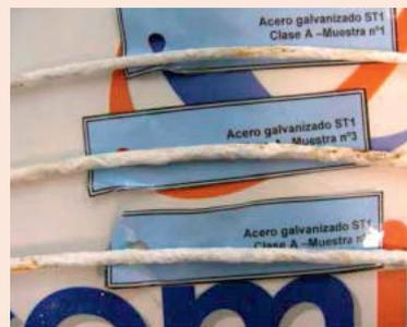
Фото 2. Провода со следами красной коррозии на образцах из оцинкованной стали ST1, класс А, после 1000 ч испытаний
