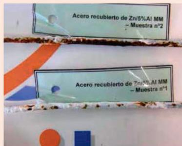
Фото 3. Провода со следами красной коррозии на образцах из стали, покрытой цинком, 5% Al MM, после 1840 ч испытаний.
