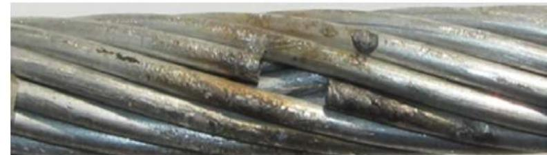
2. При протекании токов короткого замыкания трос нагревается до критических температур. Известно, что цинковое покрытие разрушается при температуре свыше 100 °C. После чего трос эксплуатируется без коррозионного покрытия. Алюминиевое покрытие не разрушается после кратковременного нагрева до 400 °C.
