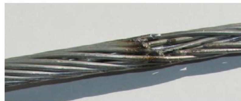
3. При попадании молнии в оцинкованный трос участок воздействия нагревается и цинк просто сгорает. Участок троса ГТК, подвергнувший разряду молнии, сохраняет коррозийную стойкость.
