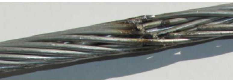
Мы провели сравнительные испытания оцинкованного троса 11,1-Г(М3)-В-ОЖ-Н-Р и ГТК20-0/70-11,1/87, плакированного алюминием, на стойкость к воздействию токов короткого замыкания, в лаборатории НТЦ ФСК ЕЭС.
